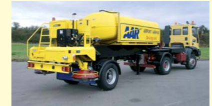
• Flüssig-Enteiser 9 000 l 2-Teller Sattelaufleger Streubreite 16 m
