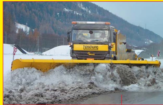
Marcel Boschung AG | Hochleistungs-Multifunktionsfahrzeug Jetbroom als in Schmitten Flughafenversion mit MF 84 Schneepflug (8m40)
