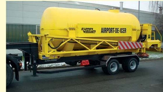
• Flüssig-Enteiser 16 000 l 3-Teller Sattelaufleger Streubreite 24 m
