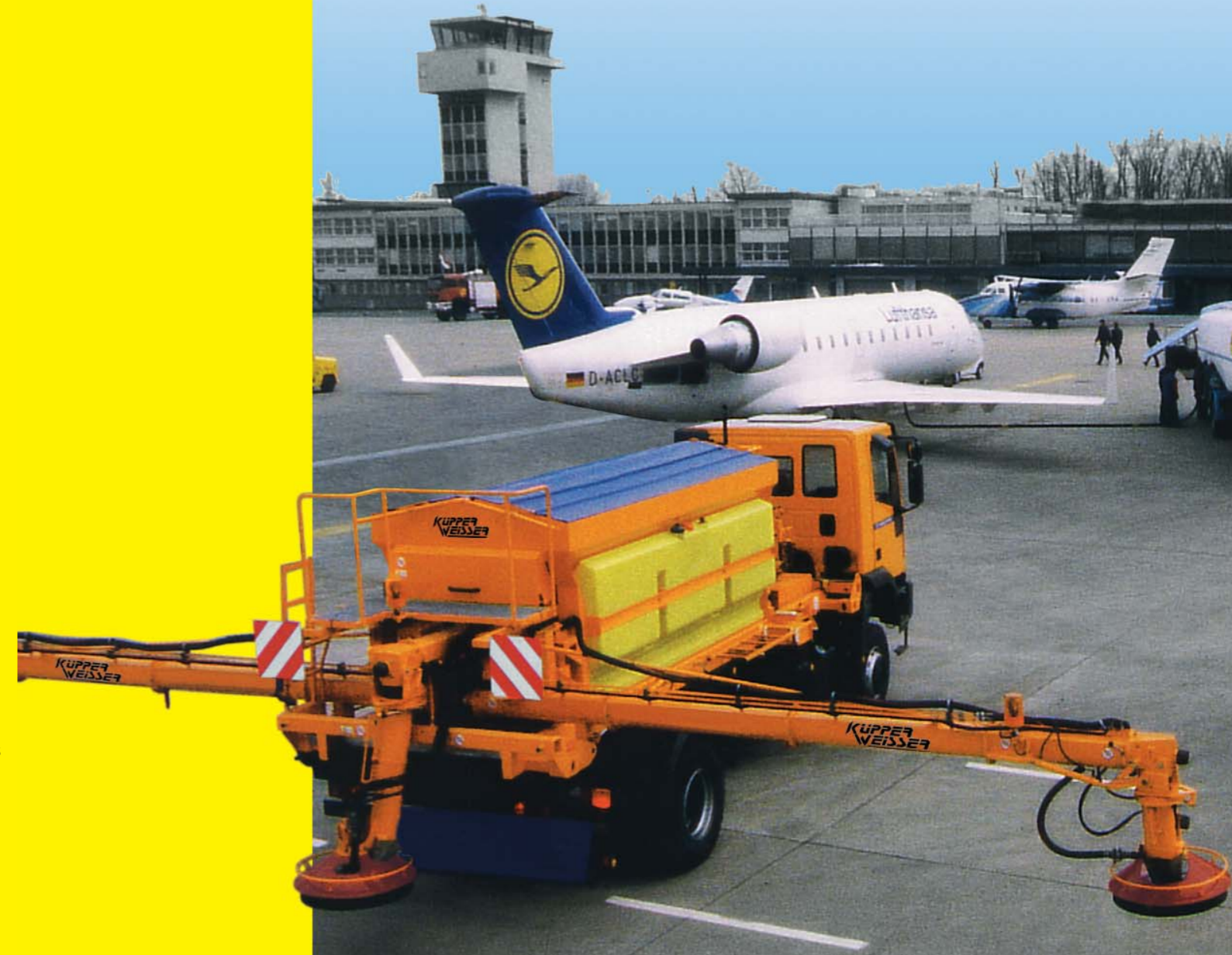
Marcel Boschung AG | Hochleistungs-Multifunktionsfahrzeug Jetbroom als in Schmitten Flughafenversion mit MF 84 Schneepflug (8m40)
