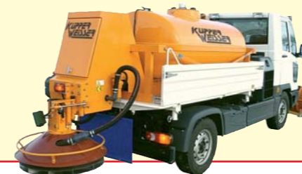
• Klein-Flüssig-Enteiser 2 000 l 1 Teller Streubreite 1,5 – 8 m
